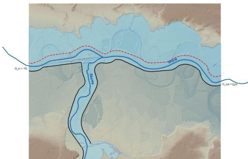
Rys. 7. Usunięcie obwałowania lewostronne dla rzeki głównej
